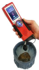
Medição da Densidade: Submergir a amostra na água
