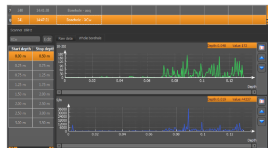
Dados no modo Borehole (poço) do Geo View 2
