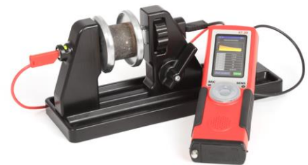
Módulo IP/Resistividade com amostrador tipo braçadeira
